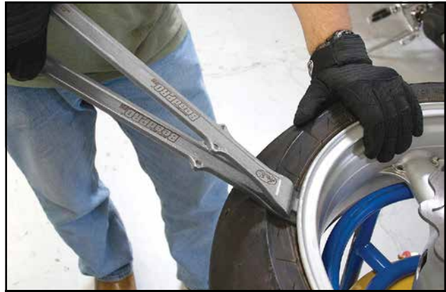
Der BeadPro FS Reifenheber von Motion Pro ist aus geschmiedetem Stahl gefertigt und hat einen längeren Griff, was ihn zum idealen Werkzeug für Reparaturbetriebe und Werkstätten macht.
