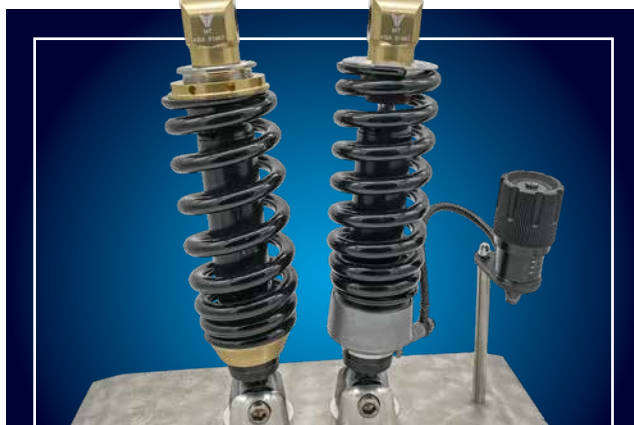
Il kit di abbassamento di Müller Motorcycle è adatto a tutte le Softail con motore Milwaukee-Eight e può essere regolato in continuo fino a 1,6 pollici (40 mm). È ideale per i motociclisti che desiderano migliorare l'ergonomia della moto.
