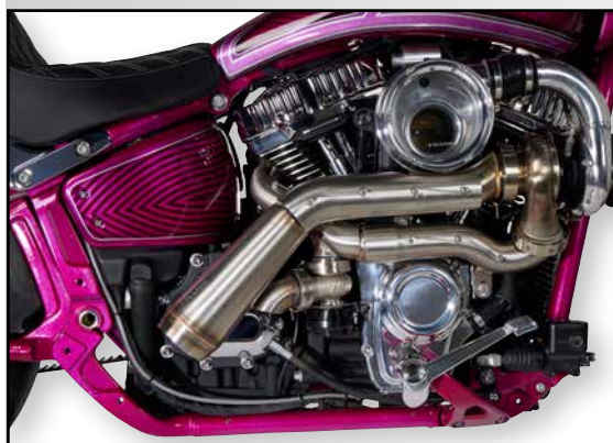
El kit turbo Tornado de Trask rezuma velocidad incluso en foto. Y no sin motivo, ya que proporciona un aumento de potencia de entre el 40% y el 50%.
