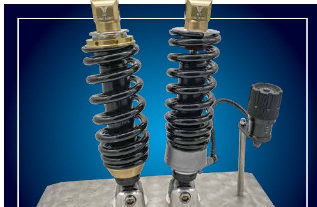
Este kit Müller Motorcycle para rebajar suspensión es compatible con todas las M8 Softail y ofrece una capacidad de ajuste continua hasta los 40 mm (1,6 pulg.), haciéndolo ideal para usuarios que busquen mejorar la ergonomía de su montura.
