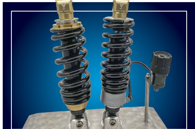
Der Müller Motorcycle Tieferlegungs-Satz passt auf alle M8 Softails und kann stufenlos bis 1,6" (40 mm) eingestellt werden. Perfekt für alle, die ihr Bike ergonomischer machen wollen.
