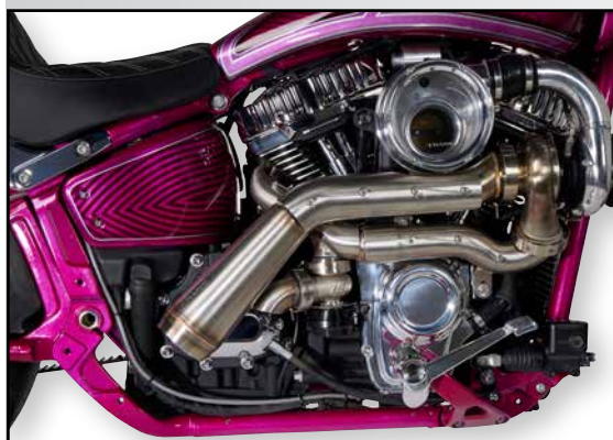
Das Tornado Turbo Kit von Trask sieht schon im Stand richtig schnell aus. Und das aus gutem Grund: Das anschraubbare Upgrade sorgt für einen Leistungszuwachs von 40 bis 50 Prozent.
