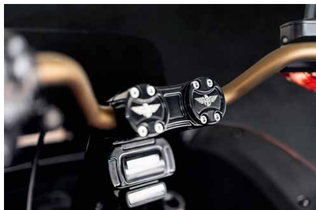
In quanto al cruscotto, i riser Clubstyle da 10 pollici di HeinzBikes e il supporto strumentazione offrono un ottimo comando e controllo.
