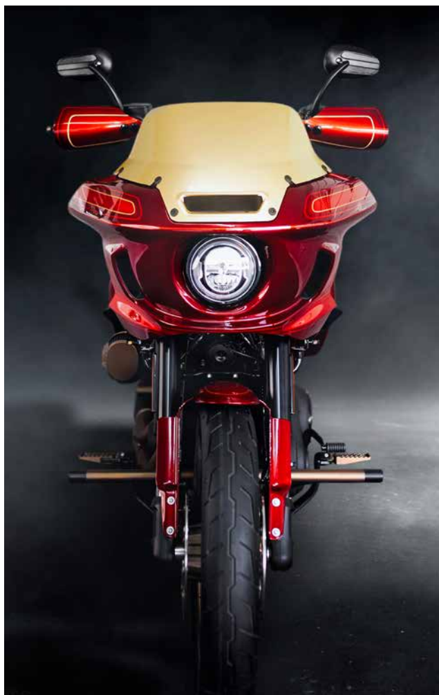
Sul davanti, il paramotore è un vero gioiello di grande stile e mantiene anche una certa distanza tra la moto e il terreno. Le luci NANO ST sostituiscono gli indicatori di direzione di serie.
