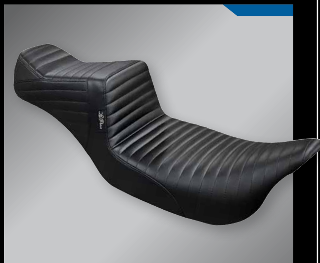
Les pilotes de moto Touring qui veulent un peu plus d'espace pour leurs jambes peuvent opter pour la selle TailWhip Daddy Long Legs. Celle-ci est de style semblable à la selle TailWhip classique, sauf que l'assise pour le pilote est reculée de presque 6 cm.
