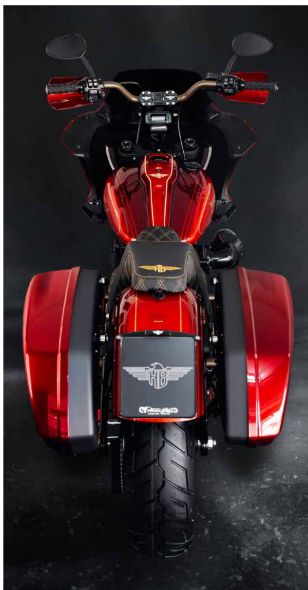
Un support de plaque d'immatriculation NANO tout-en-un HeinzBikes est fixé à l'arrière de la moto. Il remplit, hormis sa fonction primaire, les fonctions de clignotants arrière et de feux arrière. Ce support est compatible avec les plaques d'immatriculation de 10 pays.
