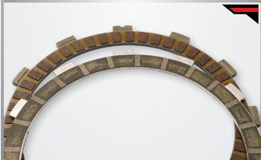
Für mehr Grip besitzen die BDL Kupplungsscheiben (unten) größere Reibbeläge als die Original-Scheiben (oben).
