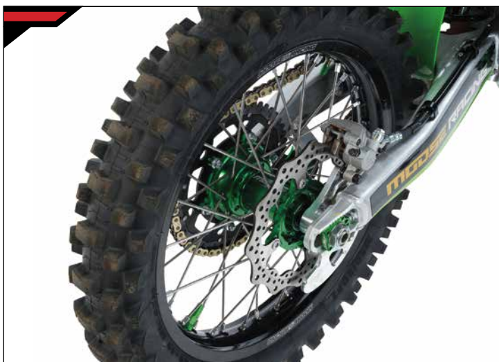
À l'arrière, le modèle s'est vu doter d'une couronne Dual Moose Racing, d'un protège-disque Shark Fin et d'un disque de frein RFX.
