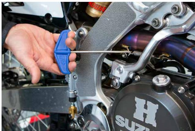
Le microcrochet à ressort de Motion Pro est économique et extrêmement utile. Il peut être employé pour étirer les ressorts d'échappement et extraire les goupilles fendues ou pour ôter des éléments tels que les chaînes de distribution ou le matériel de montage qui est tombé.
