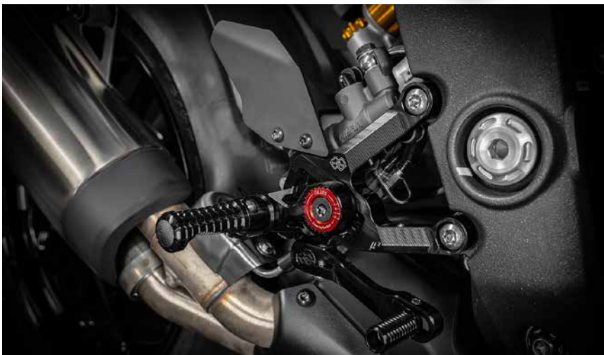
Die neuen zurückverlegten MUE2-Rastanlagen von GILLES für die Triumph Speed Triple RS und RR bieten eine große Auswahl an Fußrastenpositionen, die mit minimalem Aufwand und wenigen Werkzeugen eingestellt werden können. Die raffiniert bearbeiteten Komponenten bieten auch ein erhebliches Design-Upgrade.
