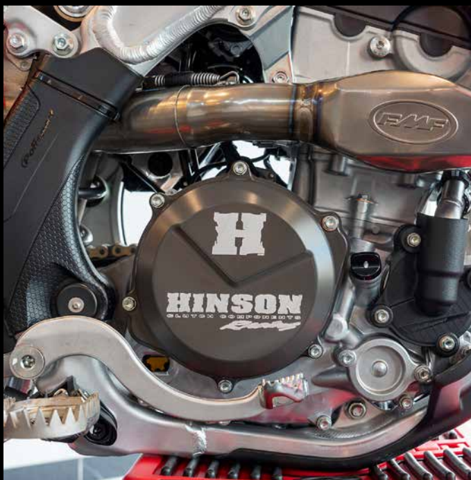
Das Honda CRF250R Projekt-Bike ist mit einem präzisionsgefertigten und hartbeschichteten Kupplungsdeckel von Hinson ausgestattet.
