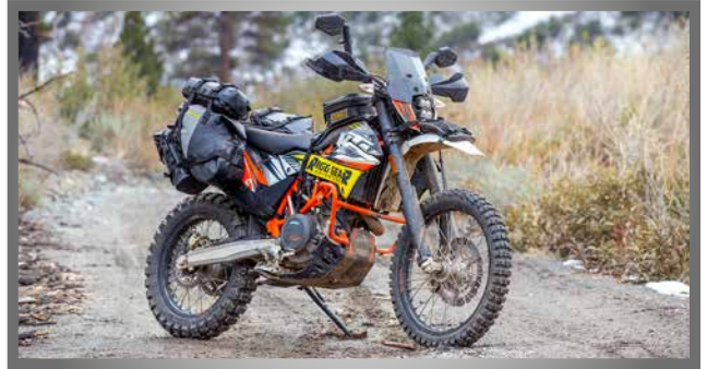
Das Hurricane-Gepäck von Nelson-Rigg ist aus strapazierfähigen, UV-behandelten PVC-Planen gefertigt. Die langlebigen Taschen sind zu 100 Prozent wasserdicht.
