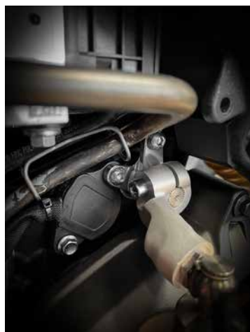
Um eine Schwachstelle in der Leistung der Speed Triples zu beheben, hat GILLES den SHIHO-Schaltungsträger entwickelt, der die Schaltwelle der Motorräder dort stabilisiert, wo sie aus dem Motorgehäuse heraustritt.
