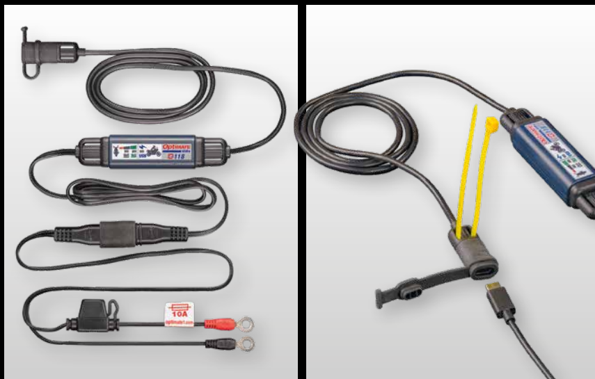
Das OptiMate USB O-118 ist ein USB-C Ladegerät, welches 3300 mA Ladestrom für Schnellladung über einen einzigen USB-C Anschluss liefert. Es besitzt ein komplett abgedichtetes Gehäuse, eine einfach mit Kabelbindern zu montierende USB-Buchse und ein Batteriekabel mit Sicherung.
