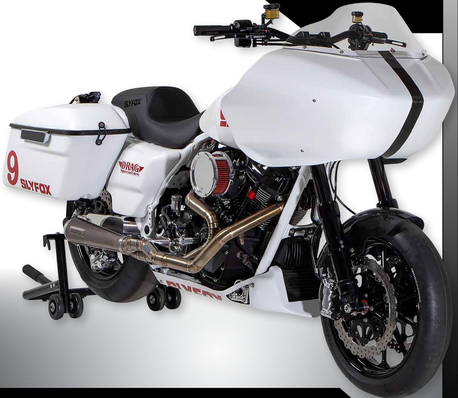
Naturalmente, questo modello contiene molti dettagli SLYFOX. Oltre ai leggeri parafanghi e valigie laterali in fibra di carbonio, anche l'esclusiva carenatura e la carena inferiore, sempre in fibra di carbonio, le ruote e i dischi freno sono di SLYFOX. Lo scarico, completamente in titanio, è frutto della collaborazione tra SLYFOX e Bassani.
