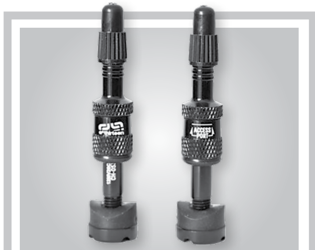
Las válvulas Quick Fill Plasma de e*thirteen se conectan directamente al tubo de líquido sellante facilitando enormemente el montaje de cámaras y cubiertas.
