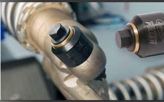
Les travaux de maintenance sur la suspension, par exemple, sont largement facilités par ces outils spéciaux. L'extracteur de roulement d'amortisseur de Motion Pro est un petit accessoire pratique qui transforme l'installation des roulements sphériques supérieurs sur les amortisseurs arrière de
