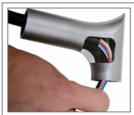
Les guidons de la gamme EZ Install de Fat Baggers, Inc. possèdent deux caractéristiques uniques : une très grande cavité interne qui facilite l'extraction du faisceau de câblage par le galbe et une structure à deux pièces inédite qui demande une surface de rangement moins importante et implique une baisse des frais d'expédition.
